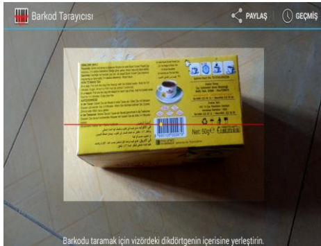
Resim 1. Zxing Kütüphanesi ile uygulama içinden barkod'ların alınması[10]
